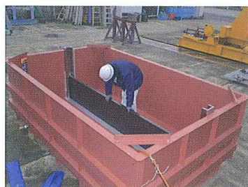
① テスト専用水槽に超軽量カーボン止水板を設置 20秒で準備完了
